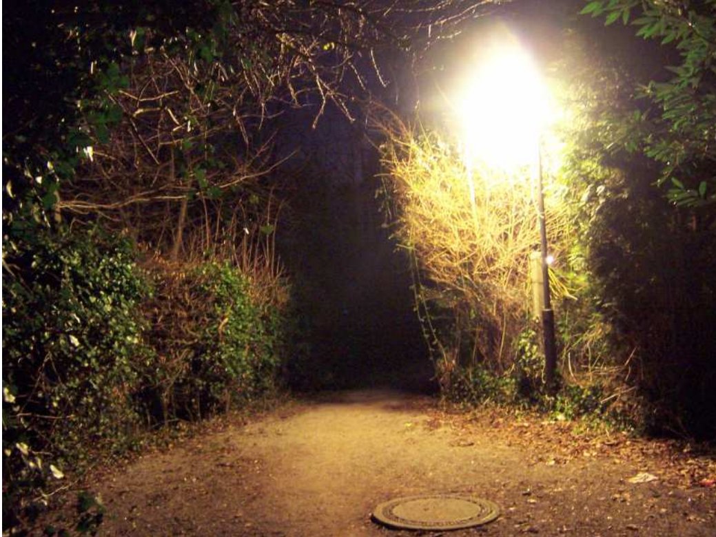
Abbildung 3: Diese Leuchte beim Haus Toholte blendet, so dass auf dem Weg zwischen den Büschen ein gefährliches „Lichtloch“ entsteht.
